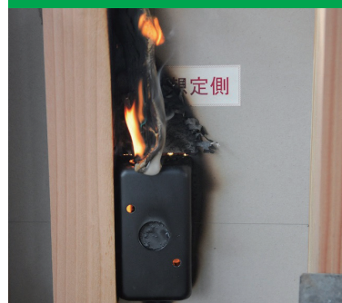
鋼製カバー付スライドボックス (加熱15分後)
