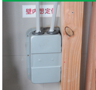
鋼製カバー付スライドボックス (加熱15分後)
