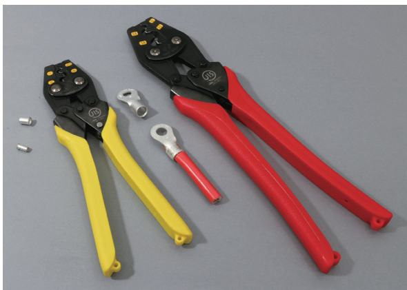
ハンドプレスの横にあるのが圧着端子(上)と電線(下)
